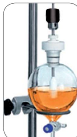
Сущность метода заключается в извлечении хлористых солей из нефти горячей водой и индикатором.
