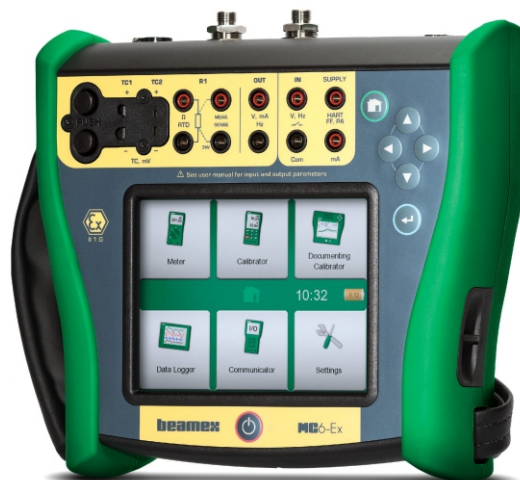
Ex-маркировка 0Ex ia IIC T4 Ga X
