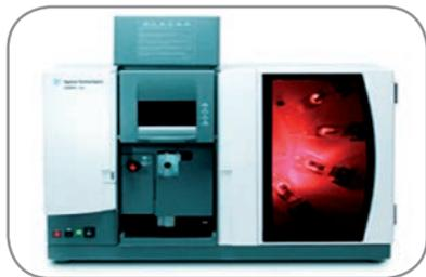
Определение целого ряда ионов металлов (щелочных и щелочно-земельных, тяжелых металлов, токсичных элементов) в воде и в почве методом атомно-абсорбционной спектрометрии (ААС)
